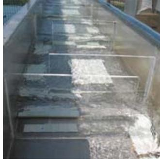
**Figure 18** : Photo des chicanes en plexiglas installée dans le canal 1 pour crée des zones contrastées de vitesse de courant
