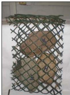
**Figure 25** : photographie d'une unité de prélèvement (sac contenant 3 cailloux autoclavés et identifiés)
