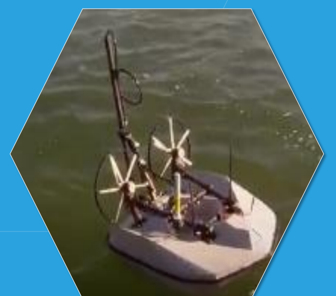
Drone aquatique, en cours de développement et d'application (Société Spyboat et INRA).
