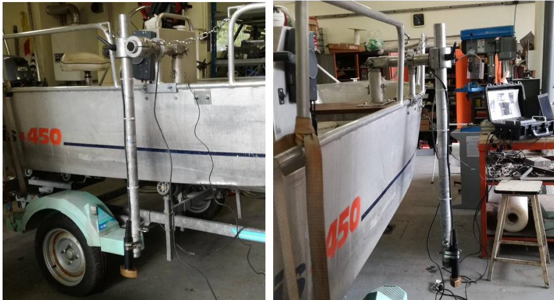
Figure 6 : Montage assurant l'horizontalité du transducteur
