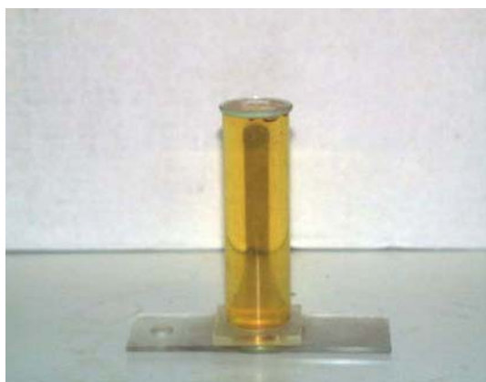
Photo 2 : Chambre de sédimentation
