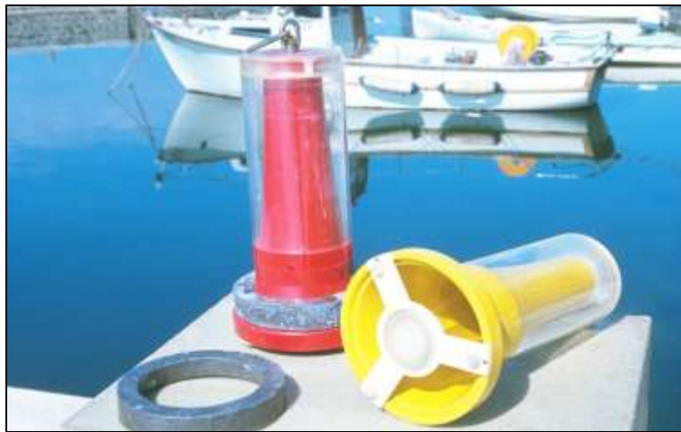
Photo 1 Appareil intégrateur collecteur du phytoplancton
