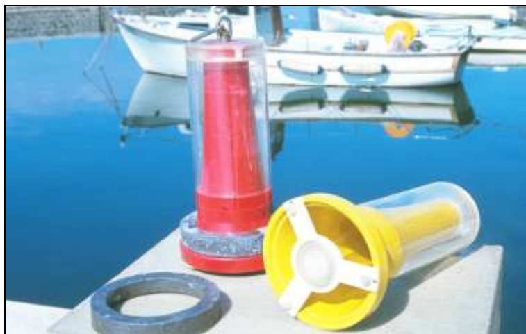
Photo 1 Appareil intégrateur collecteur du phytoplancton
